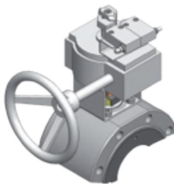
**RIDUTTORE MANUALE E FINECORSA**
