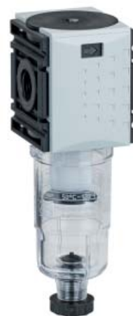
Material: Grivory (PA66) Prüfdruck 48 bar = Berstdruck nach ISO 6953
