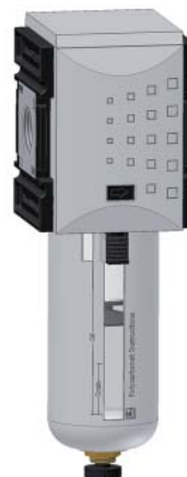
Material: Grivory (PA66) / IXEF1022 Prüfdruck 64 bar = Berstdruck nach ISO 6953
