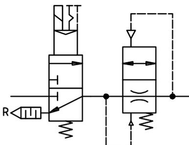
Belüftung der Anlage über Drosselstellung des Anfahrventils.
