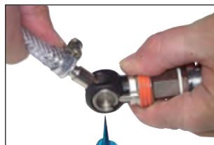
Kupplung ausschwenken - Kupplung schließt und entlüftet
