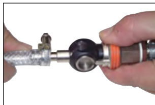
Entriegeln der Sicherheitshülse
