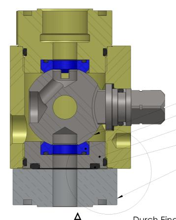
Kugel ø43mmDichtelementeinstellbare VerschraubungO-Ring 30,00 x 4,00 NBR70
