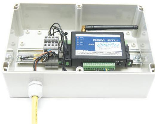
im Gehäuse IP65, anschlussfertig und kompatibel zu unserem Bussystem, mit geregelter Heizung.
